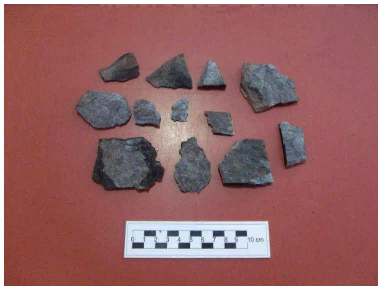
Figura 40 Placas de folhelho obtidas por meio de ação e choque térmico. Márcio Amaral
